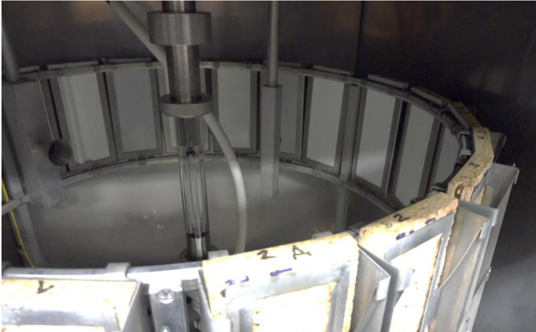
Anordnung der Prüfkörper im Xenon Weather Ometer Ci3000+. Foto: EPH Dresden
