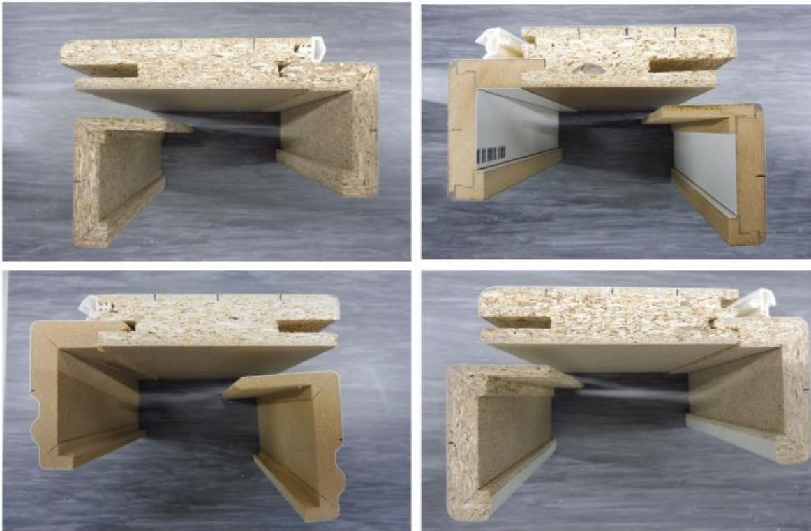
Unterschiedliche Zargenkonstruktionen dienen als repräsentative Prüfmuster. Fotos: EPH Dresden
